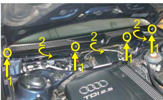
**PL** Odkręcić wkręty mocujące osłonę podszybia. Zdemontować element maskownicy podszybia
