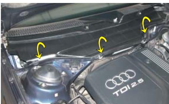
**PL** Wyciągnąć pokrywę znajdująca się nad komorą filtra
