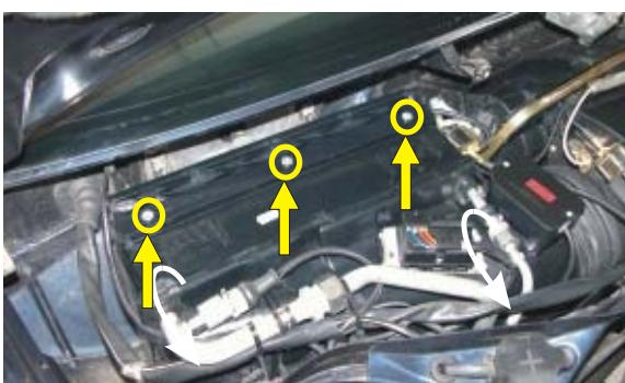
**PL** Odkręcić wkręty pokrywy filtra, usunąć pokrywę
